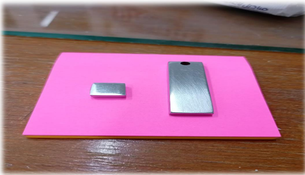
الشكل (3-2) يوضح صورة لعينة الفولاذ الكربوني N80
