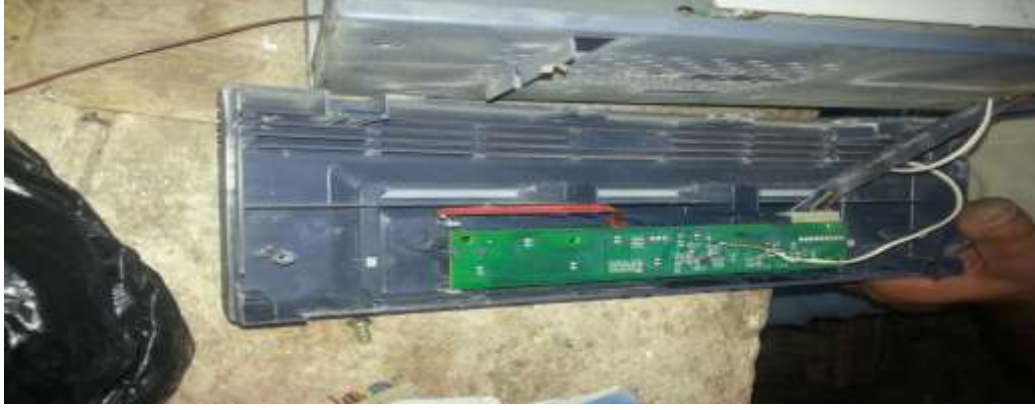
شكل (٩) يوضح هذا الشكل باطن الوجه الامامي للجهاز وتوصيل اسلاك المصابيح الامامية للدلالة على عملها عند التشغيل .
