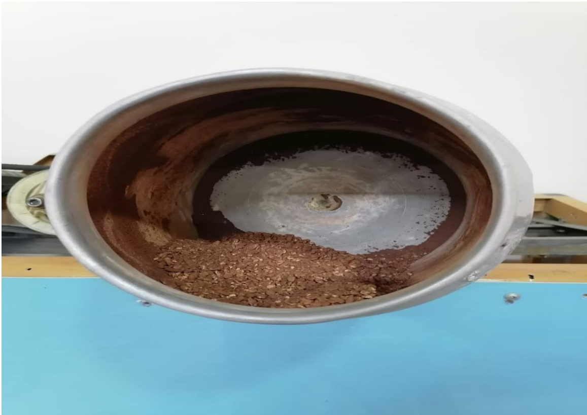
ملحق (5) صورة السماد البوتاسي اثناء عملية التغليف
