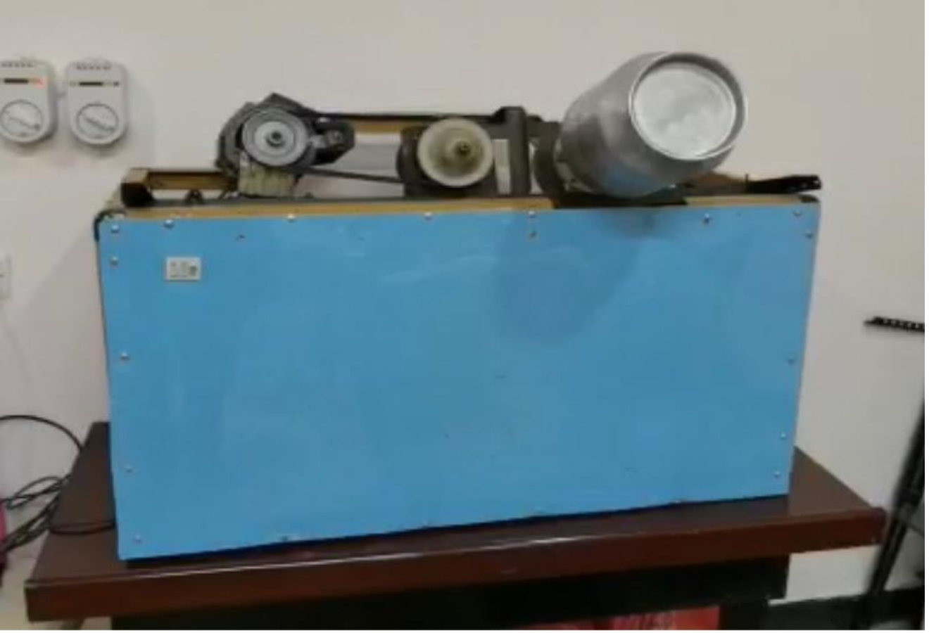
ملحق (6) صورة جهاز تغليف السماد
