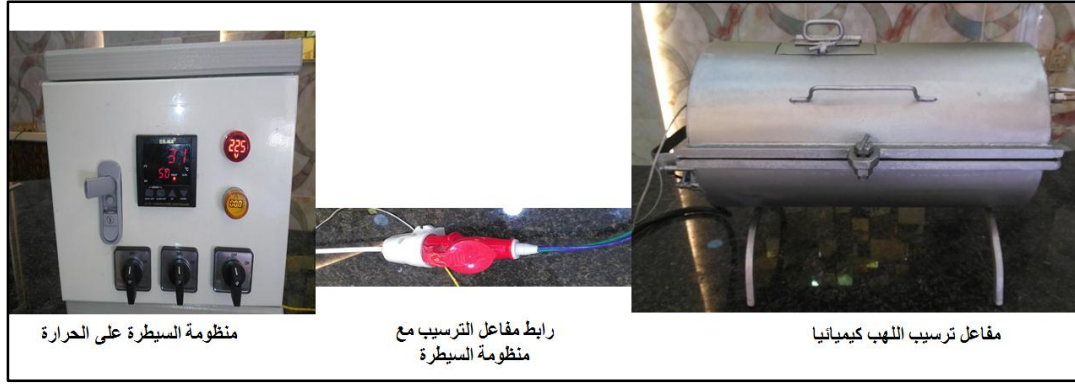
شكل (٢-٢): الشكل العام للمفاعل المصنع محليا
